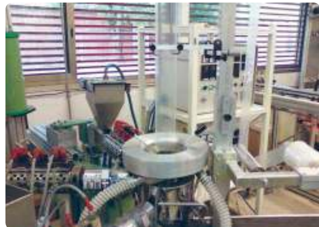
Uno degli impianti di coestrusione per la produzione di film in bolla multistrato, in dotazione al gruppo di Scienza e Tecnologia dei Materiali presso il DII.
